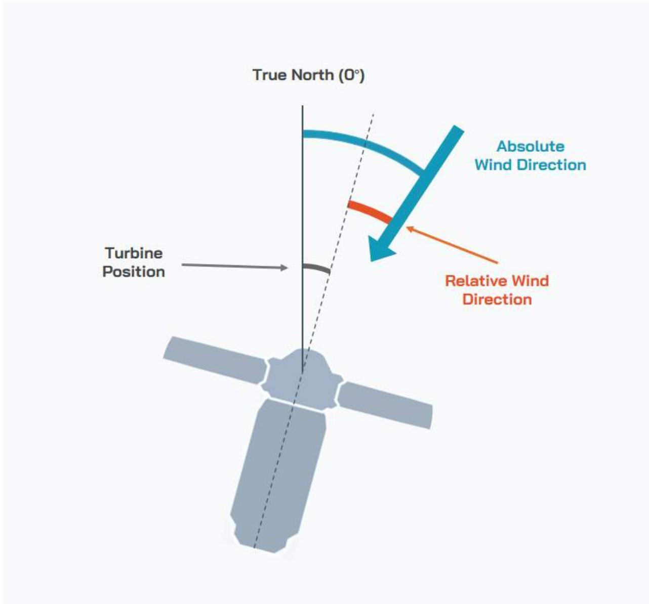
**FIGURE 2. DEFINITION OF TURBINE POSITION AND WIND DIRECTIONS**
